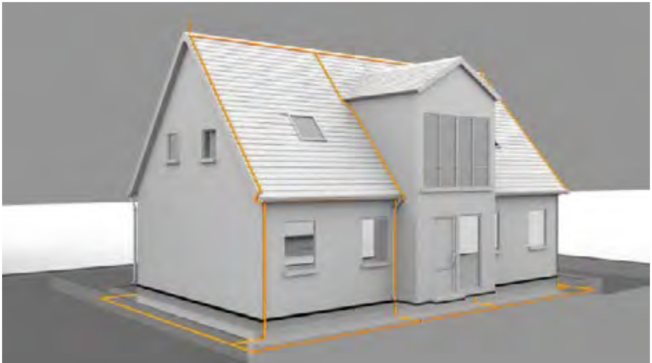
Äußere Blitzschutzanlage an einem Haus.
