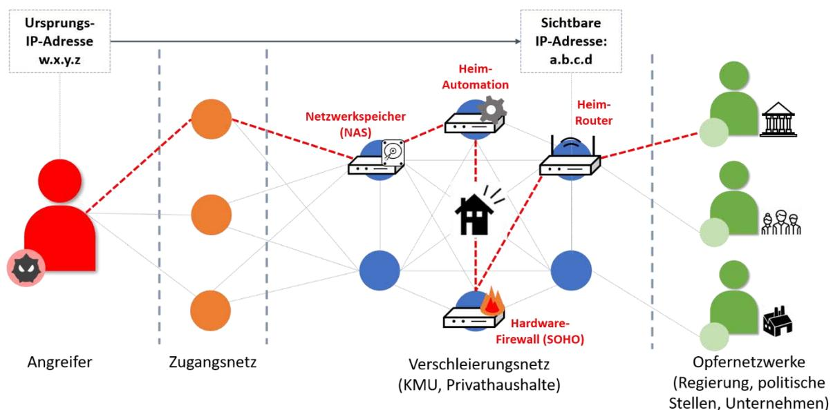
Abbildung: Schematische Darstellung eines Anonymisierungsnetzwerks
