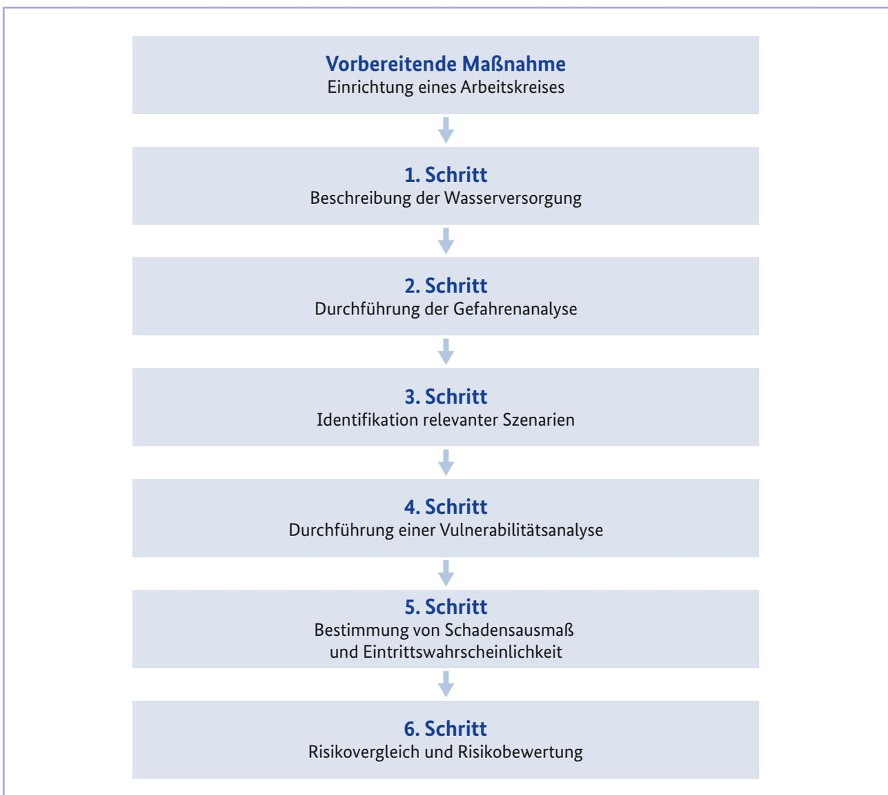
Abb. 11: Ablauf der Risikoanalyse zur Sicherheit in der Trinkwasserversorgung (eigene Darstellung)
