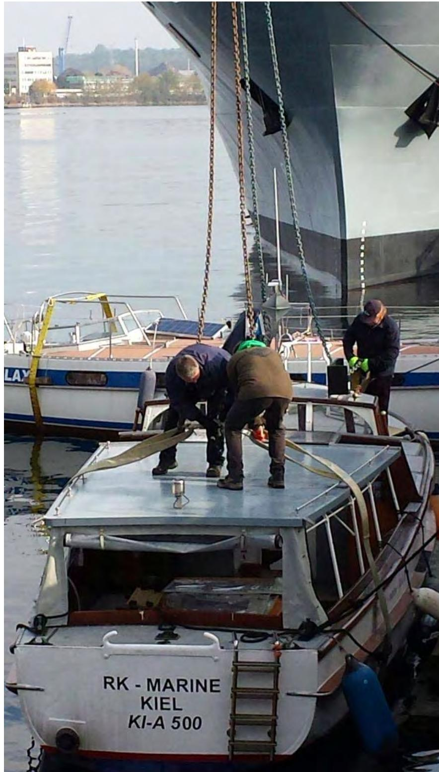
V-Boot Kuddel wird zum Kranen eingehängt
